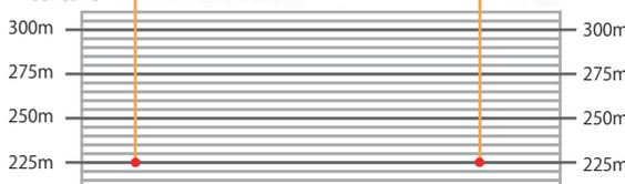
等高線は、地上の同じ高さの点をつらねて曲線を作り、それを真上から地図に投影したものです。これで、斜面の傾斜の度合いもわかります。
